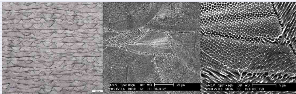
Mikrostrukturen von gesinterten Cobaltchrom-Bauteilen (geätzt) 10 fach (optisch) 1000 fach (REM) 5000 fach (REM)
